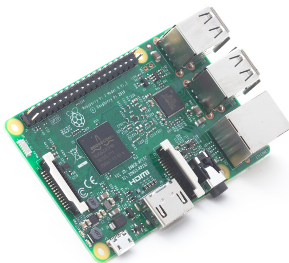
Slika 2.6: Mikroračunalnik Raspberry PI 3, vir: [9]
