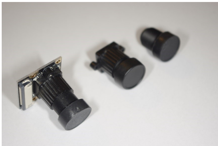
Slika 29: Tiskano vezje s CCDjem in nastavkom za lečo, ter dve leči.
