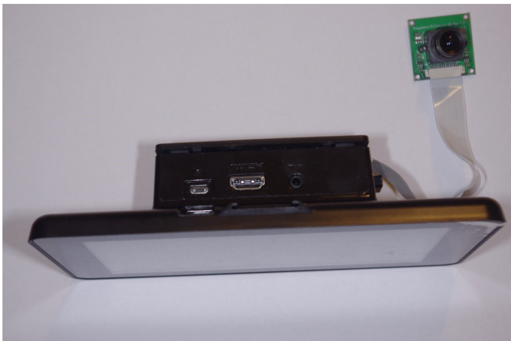
Slika 28: Raspberry Pi 3 z velikim LCD ekranom v ohišju in kamera druge generacije.
