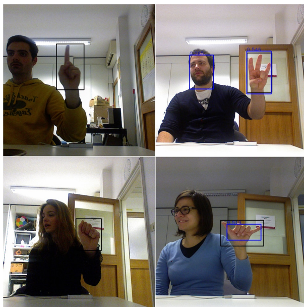
Slika 17: Primeri napačnih detekcij dlani iz eksperimenta M1_T1, zaradi zameglitve, ki je posledica premika (levo zgoraj), slabe osvetlitve (levo spodaj), napačno detektiranega obraza (desno zgoraj) in prenizkega IOU (desno spodaj)
