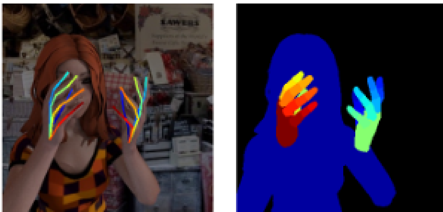
Slika 4: Primer iz podatkovna množice, ki ga sestavljata segmentacijska maska z 33 razredi (trije za vsak prst, dlan, oseba in ozadje) ter tridimenzionalni model, ki vsebuje 21 značilke za vsako roko (štiri značilke za vsak prst in eno značilko blizu zapestja) [40, Slika 4]
