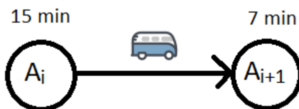
Slika 5.3: Ko je čas prihoda na postajo A_i večji od A_{i+1} , se avtobus nahaja nekje med postajo postajo A_i in A_{i+1} . (vir ikone: Bus Icon)
