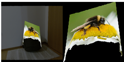
Slika 8: Anamorfoza v oblaku 3D točk (levo) in projecirana anamorfično deformirana slika (desno).
