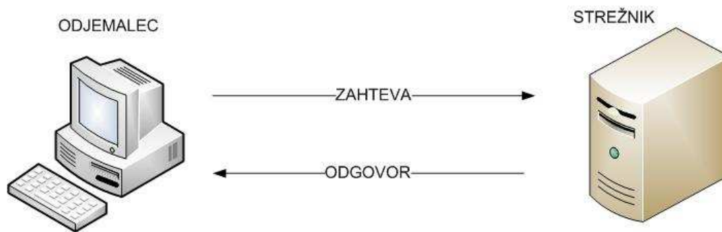
Slika 1: Pri arhitekturi odjemalec strežnik odjemalec pošlje zahtevo. Strežnik izvede zahtevano operacijo in vrne odjemalcu odgovor.
