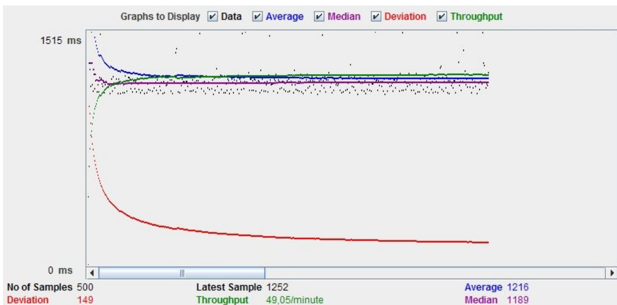
Slika 24. Graf hitrosti obdelave zahtevkov portala Joomla brez vklopljenega predpomnjenjem izmerjeno z orodjem JMeter.
