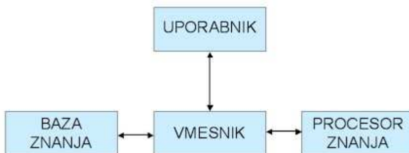
Slika 14. Osnovni diagram ekspertnega sistema [13]
