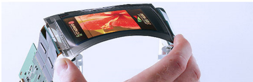
Slika 16: Primer prototipa gibljivega PLED zaslona: prvi visoko ločljivi aktivno matrični OLED zaslon zasnovan na fleksibilni kovinski foliji z uporabo aktivne matrike iz amorfnega silicija (a-Si) in PHOLED tehnologije. To je barvni zaslon z 100 ppi in ima 256 odtenkov na barvo (8 bit). Ta prototip je bil prikazan leta 2007 na srečanju »Society for Information Display Conference and Symposium« v Kaliforniji (povzeto po [7]).
