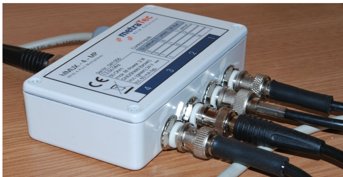
Slika 5. Multiplekser hfMUX-4-MP povezan s štirimi antenami.
