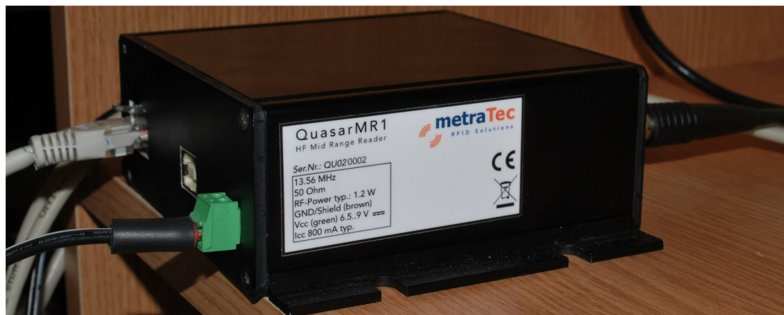
Slika 4. Čitalec QuasarMR1, priključen na napajanje in povezan s kablom UTP.
